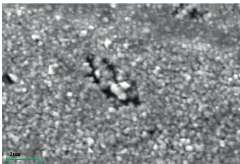
Рис. 1. Изображение поверхности стеклоглеродного электрода, модифицированного никельсодержащими наночастицами
